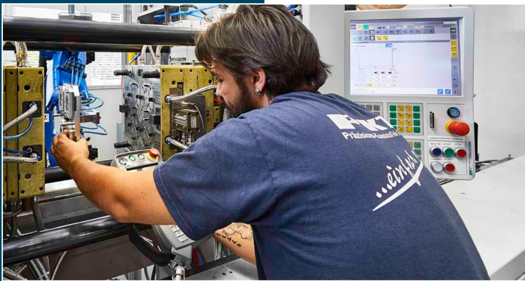
Bild links: Qualität bis ins Detail wird etwa durch eine computertomografische Untersuchung von Spritzteilen sichergestellt. Bild Mitte: Das Einrichten des Handlings an einer Maschine trägt zu einer fortlaufend hohen Qualität durch exakte Teileentnahme bei. Bild unten: Entwicklung und Konstruktion: Hier wird vorgedacht, wie die geplanten Spritzteile reibungslos produziert werden können.
